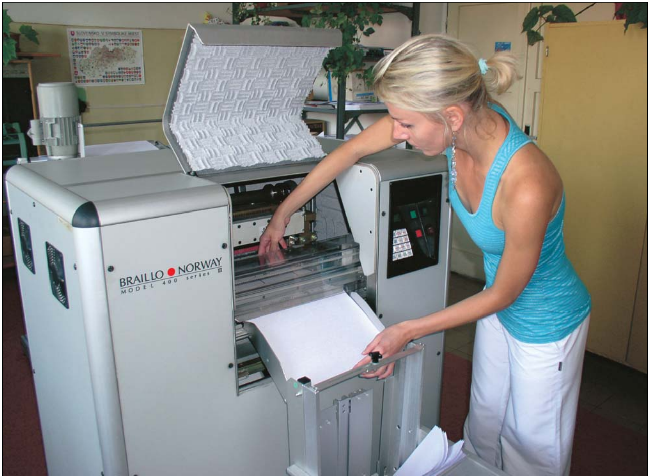
Na počítačom riadenej tlačiarni Braillo 400 SR sa tlačia všetky braillovské dokumenty z produkcie SKN. Pri obsluhu stroja je Zuzana Novosadová.
