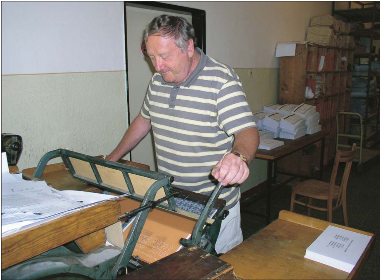
Dušan Novosad pri práci na „starčekovi“, sklápacom lise, ktorý spoľahlivo slúži desiatky rokov na braillovskú tlač.
